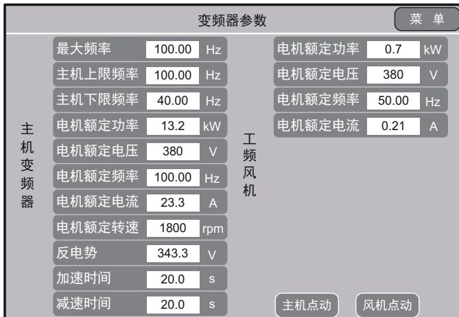
图 3-10 变频器参数设置页面（示意图）
