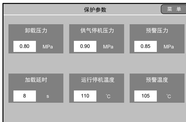
图 3-9 保护参数设置页面 (示意图)
